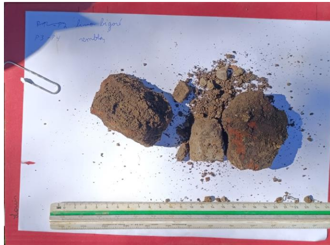
Photo 3 : Sol remblayé de nature limoneuse (points P3 et P4 – présence de briques, ...)
