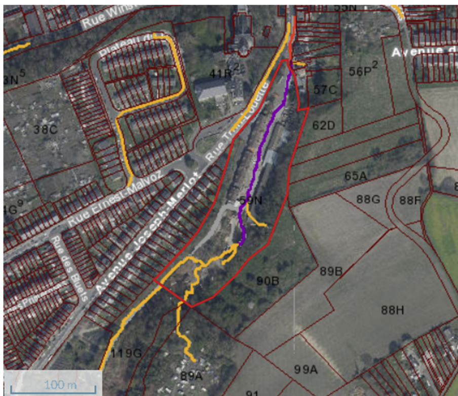
Figure 3 : axe de ruissellement concentré (source : WalOnMap)
