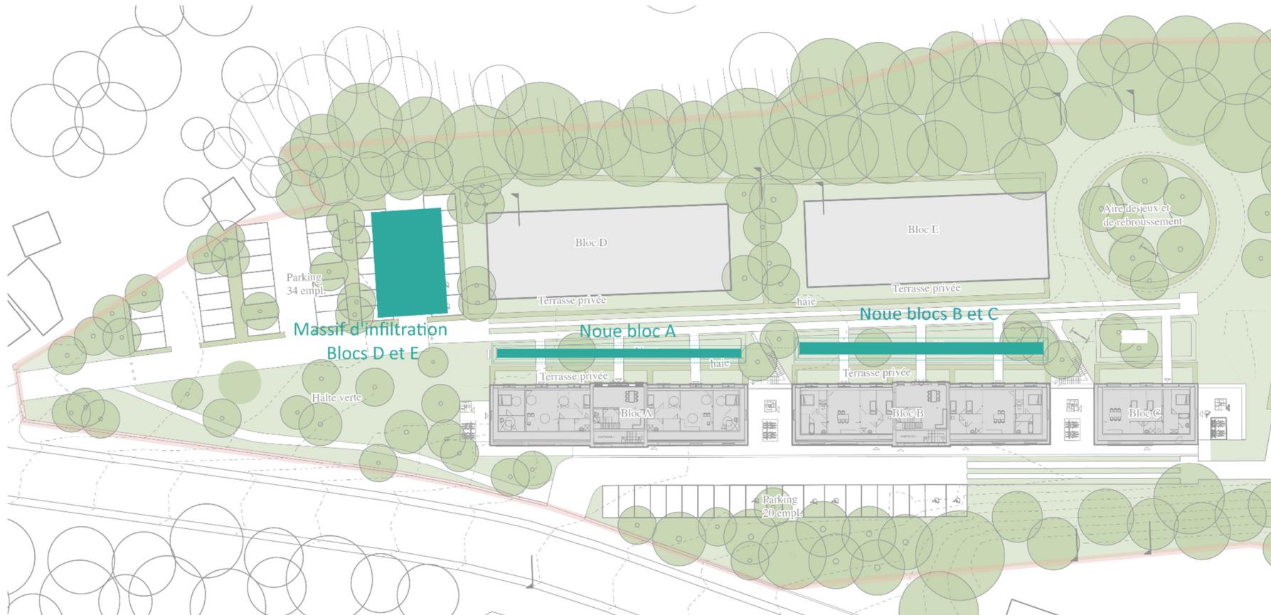
Figure 10 : implantation de l'ouvrage d'infiltration – plan de principe
